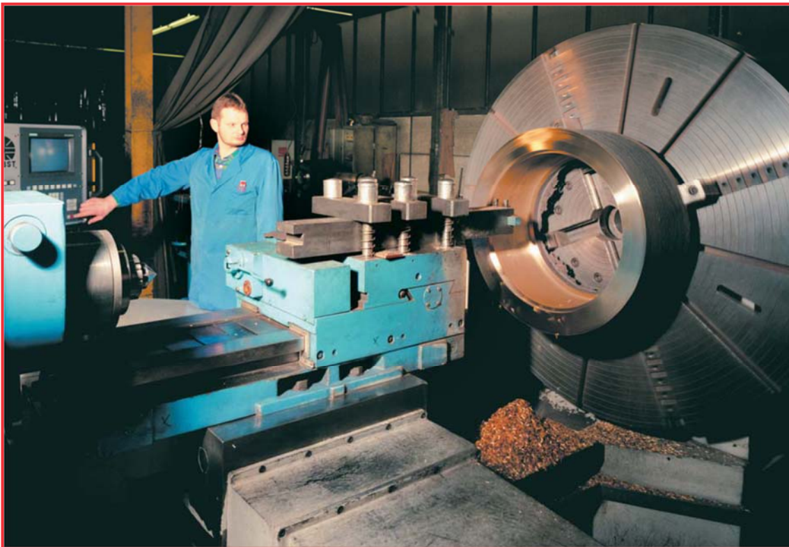
CNC-Plan- und Spitzendrehmaschine - \varnothing 1600 x 5500
